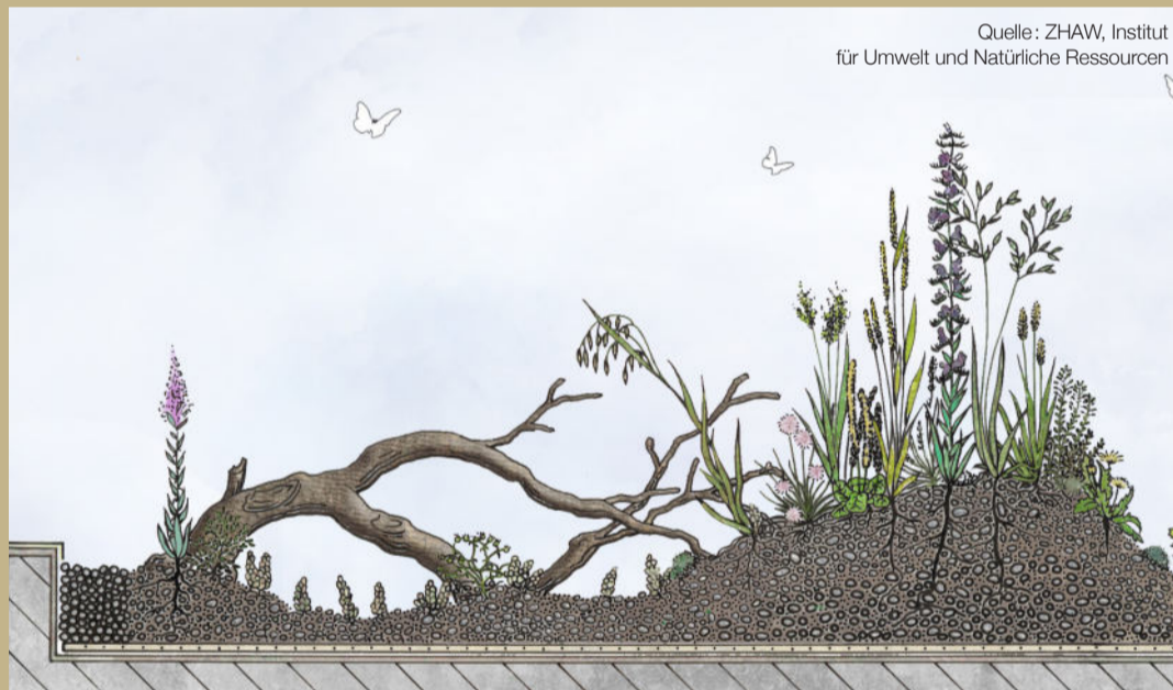
Schematischer Schnitt (nicht massstabgerecht) einer extensiven Dachbegrünung mit Mikrotopographie und Trockenholz für die Insekten.
