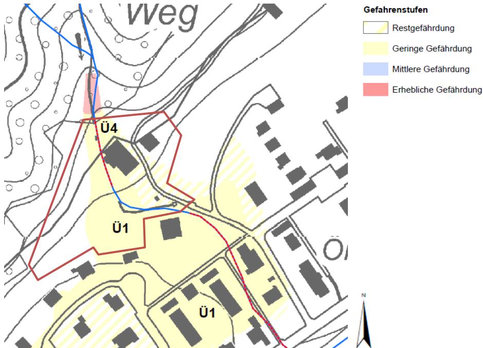
Abbildung 10: Skizzierte Gefahrenkarte nach Umsetzung der Hochwasserschutzmassnahmen am Vorder Weggräbli gemäss [3]. Rot: Ungefährer Perimeter der UeO Vorder Weg. Unmassstäbliche Darstellung.
